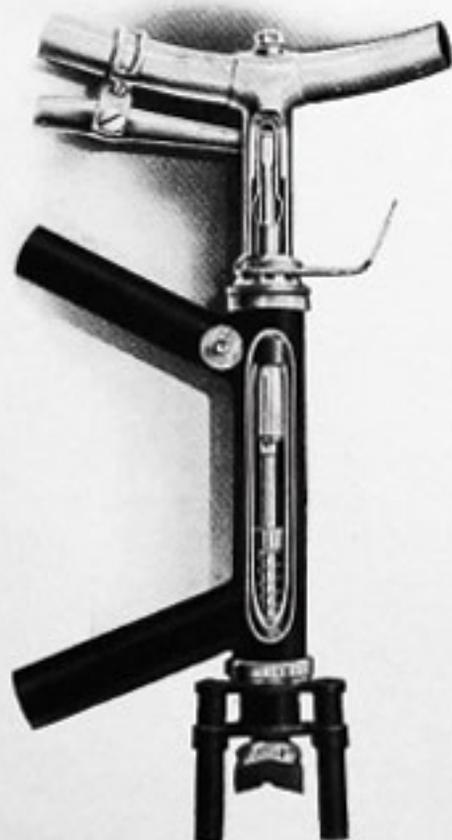
Lenkstange mit Innenklemmung und Innenbremse.
