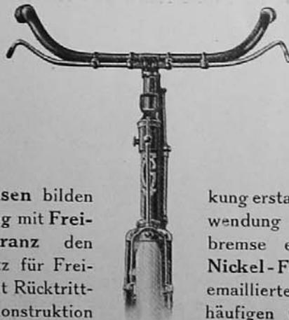
**Felgenbremsen** bilden in Verbindung mit **Freilauf-Zahnkranz** den besten Ersatz für Freilaufnaben mit Rücktrittbremse. Die Konstruktion ist einfacher und die Wir-
