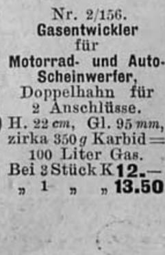
Nr. 2/156. Gasentwickler für Motorrad- und Auto-Scheinwerfer, Doppelhahn für 2 Anschlüsse. H. 22 cm, Gl. 95 mm, zirka 350 g Karbid = 100 Liter Gas. Bei 3 Stück K **12.-**
